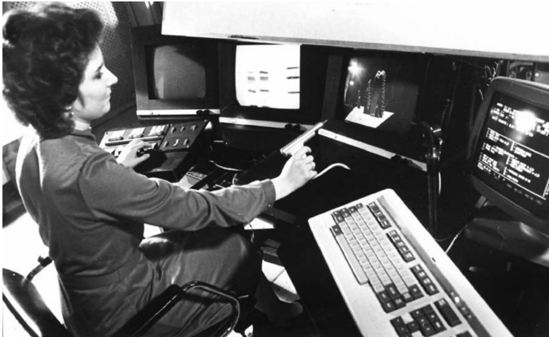
Пульт оператора сканирующей системы АЭЛТ-2/160 со скоростным световым карандашом (с обратной связью для подсветки выбранной точки) и многофункциональной клавиатурой, построенной на подходе «клавиши у руля»
