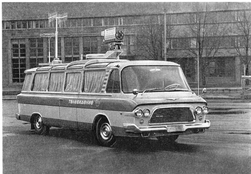
Передвижная телевизионная станция с передающей ТВ камерой на суперортиконе ЛИ-217
