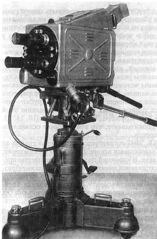
Передающая телевизион- ная камера КТ-27 на суперортиконе ЛИ-201
