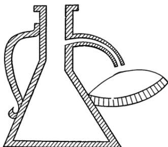
отверстие и припаял соответствующую ему по размерам изогнутую трубку с концом, обращенным к земле; ниже этого конца я приделал нечто вроде кольца для установки чаши весов во время работы... Шейку я сделал узкой потому, что уровень воды в узком пространстве поднимается выше при малейшем прибавлении чего-либо... Поскольку же мы сделали шейку шириной в мизинец, то подъем воды заметен и при опускании того, что по объему равно зерну проса»<sup>1</sup>.
