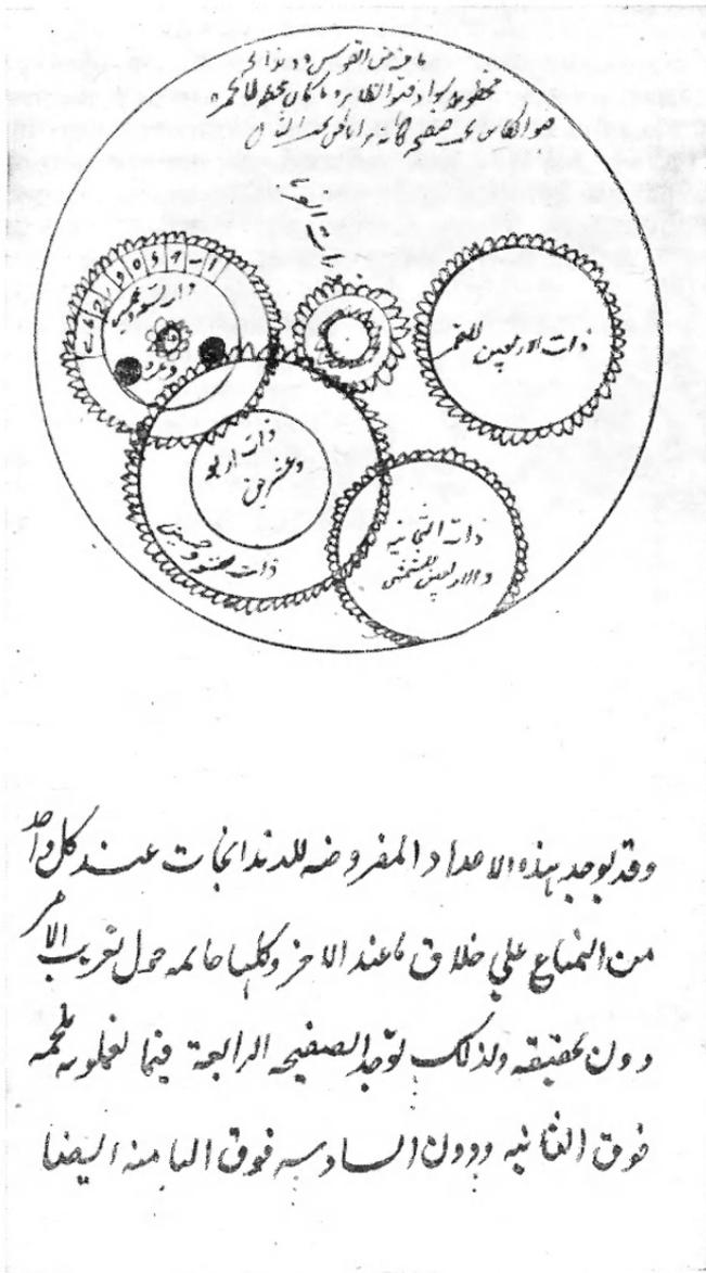
Рис. 41 Схема и описание механического календаря в «Астролябиях»
