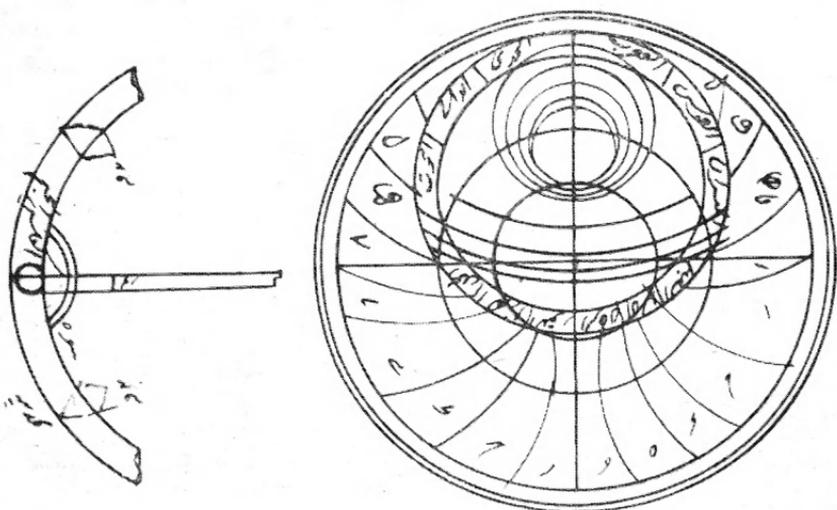
Рис. 37 Схема и описание челнообразной астролябии в «Астролябиях»
