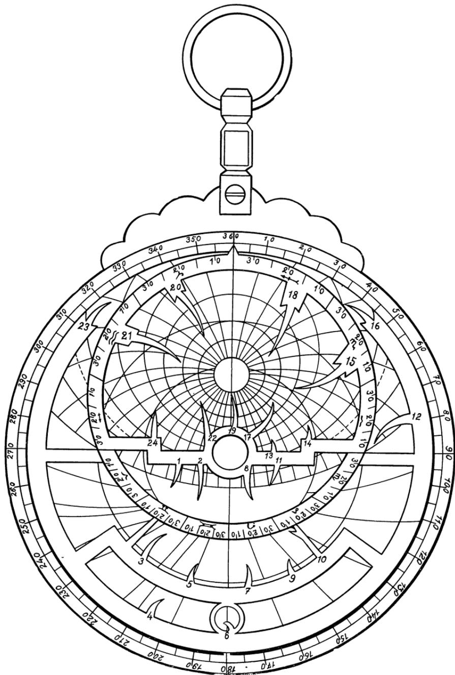
Рис. 33 Лицевая часть астролябии (тимпан и «паук»); цифры на острях относятся к неподжным звездам)
