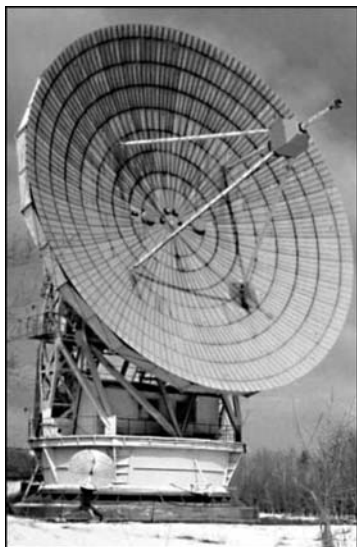
Рис. 2.3. Прецизионный радиотелескоп с диаметром зеркала 22 м Пущинской радиоастрономической обсерватории Физического института им. П. Н. Лебедева (Пущино на Оке, Россия). С благодарностью Р. Д. Дагкесаманскому
