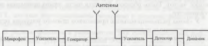
Рис. 4.4. Передача-прием радиосигнала
