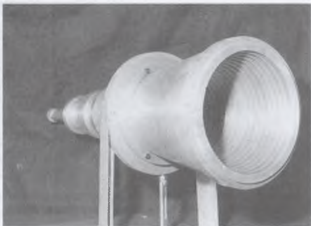
Рис. 3.36. Рупорно-цилиндрическая антенна для измерений фонового излучение Вселенной на волне 6 см (США)
