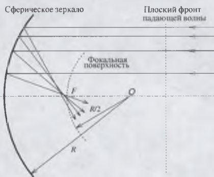
Рис. 3.26. Ход лучей при отражении от сферической поверхности; O – центр сферы радиуса R
