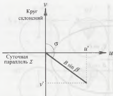
Рис. 6.8. Проекция базы на прямоугольные оси u, v
