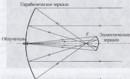
Рис. 3.16. Система Грегори
