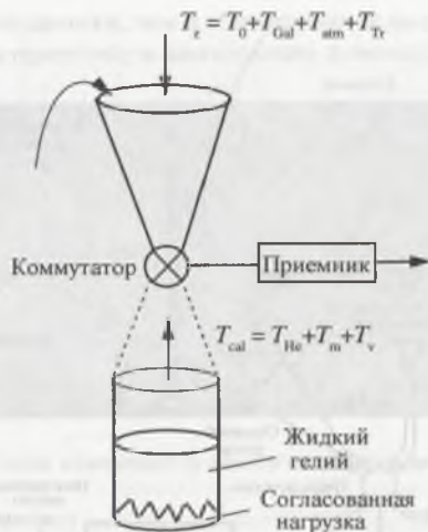
Рис. 5.21. Схема приемной системы для измерений фонового космического излучения
