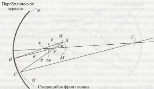
Рис. 5.3. Схема применения теневого метода юстировки зеркальных антенн
