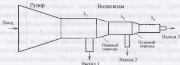
Рис. 3.8. Широкополосный облучатель для трех диапазонов длин волн: \lambda_1 > \lambda_2 > \lambda_3
