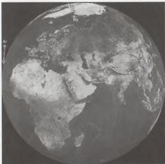
Рис. 6.35. Интерферометрическая система со сверхдлинной базой в Европе ного радиотелескопа с наземными антеннами. Рабочие длины волн составляют 1,35, 6, 18 и 92 см.
