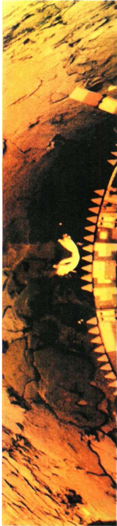
Фото 6. Цветная панорама «Венеры-14». Светлые предметы на первом плане всех панорам — подцилиндрические крышки телевизионных камер, которые сбрасывались после посадки аппаратов. Диаметр крышек около 200 мм
