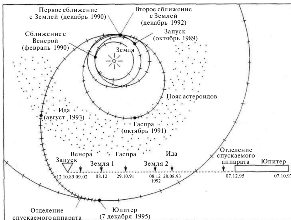
Рис. 5.1. Схема полета аппарата «Галилей» с множеством гравитационных маневров
