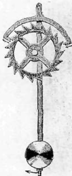
Рис. 192.—Маятникъ съ якоремъ и спусковымъ колесомъ.
