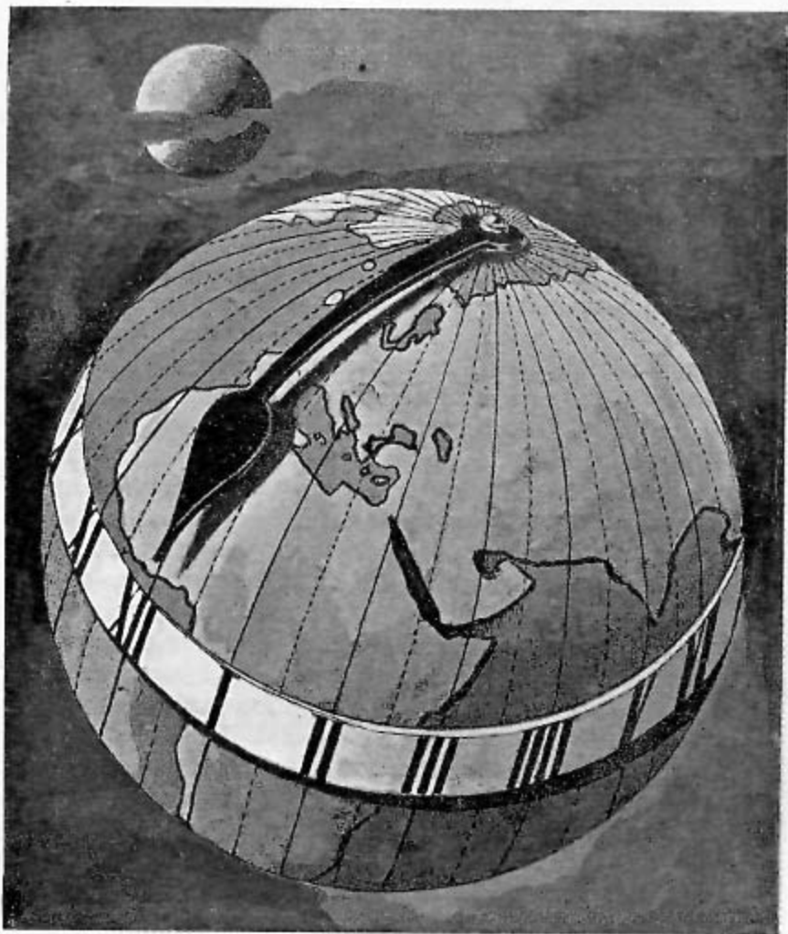
Рис. 194 — Международное время. Сплошныя линіи означаютъ меридіаны, а пунктирныя — границы зонъ. Всѣ зоны въ моментъ гриничскаго полудня считаютъ время соотвѣтственно своему меридіану.
