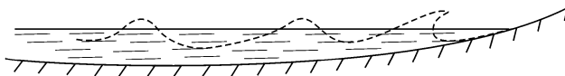
Рис. 20. Форма волн в сильно анизотропном море в преобразованной системе координат (x', y') .
