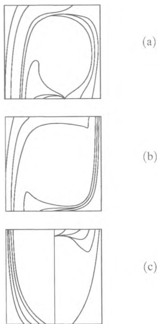
Рис. 7.5. Диаграммы силовых линий поля в вертикальных плоскостях для постоянных решений: a — через центр ячейки и среднюю точку стенки ячейки; b — через центр ячейки и вершину основания; c — по стенке ячейки (по Галлоузю и Проктору, 1981)
