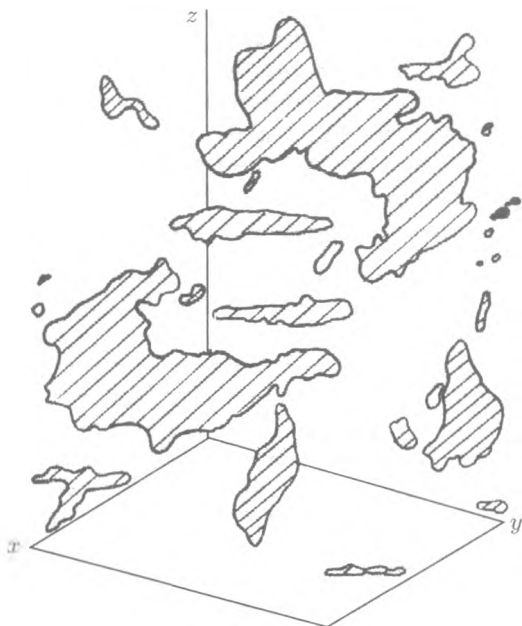
Рис. 10.4. Пространственная перемежаемость магнитного поля в нелинейном динамо. Средняя спиральность равна нулю, R_e = R_m = 100 , t = 23 . Заштрихованные участки имеют h , составляющую 95 % или более от своей максимальной величины (по Meneguzzi et al., 1981)
