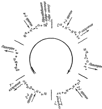
Рис. 23. Углеродная циклическая реакция, протекающая в недрах Солнца
