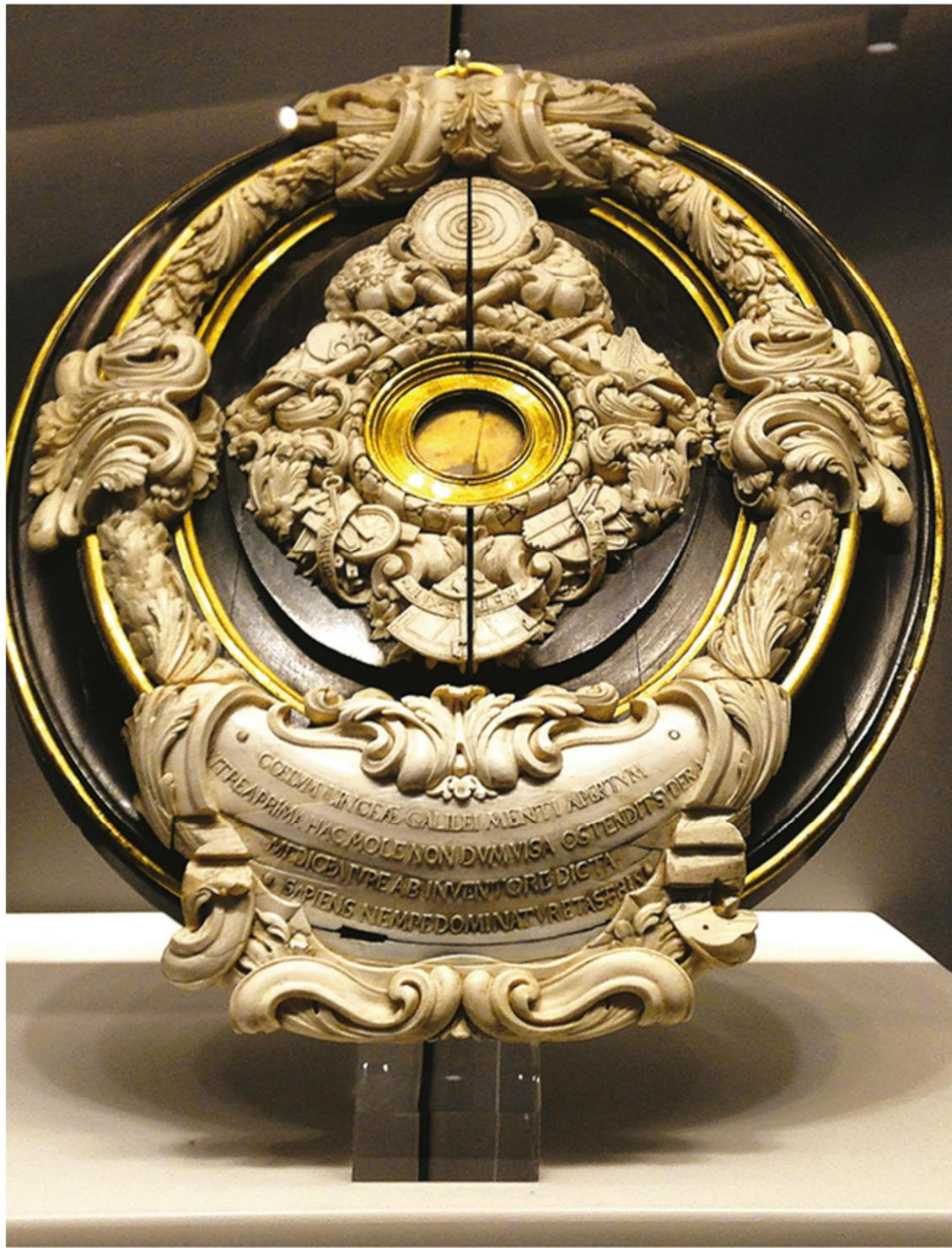
Илл. 4. Линза объектива одного из телескопов Галилея (в центре), изготовленная им в конце 1609 – начале 1610 г. и использовавшаяся во многих наблюдениях. Рама создана Витторио Кростеном в 1677 г. Хранится в Музее Галилея во Флоренции
