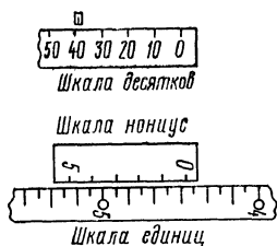
Рис. 6.5. Отсчет высоты при измерении без осредняющего механизма
