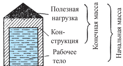
Рис. 114. Структурная схема ракеты.
