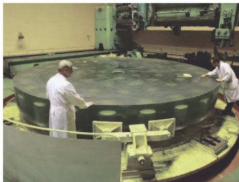
Рис. 38. Процесс шлифовки зеркала телескопа диаметром 8 метров.
