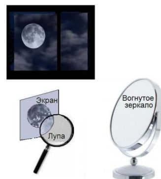
Рис. 50.2. Демонстрация принципа действия телескопа-рефлектора
