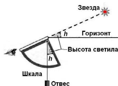
Рис. 10.4. Сборка модели квадранта
