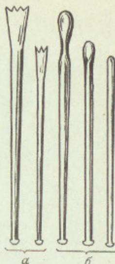
Рис. 110 Тонкий «профильный» инструмент для моделировки мрамора а — мелкие троянки; б — круглые мелкие скарпели
