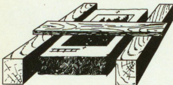
Рис. 123. Доска для упора руки при работе на камне
