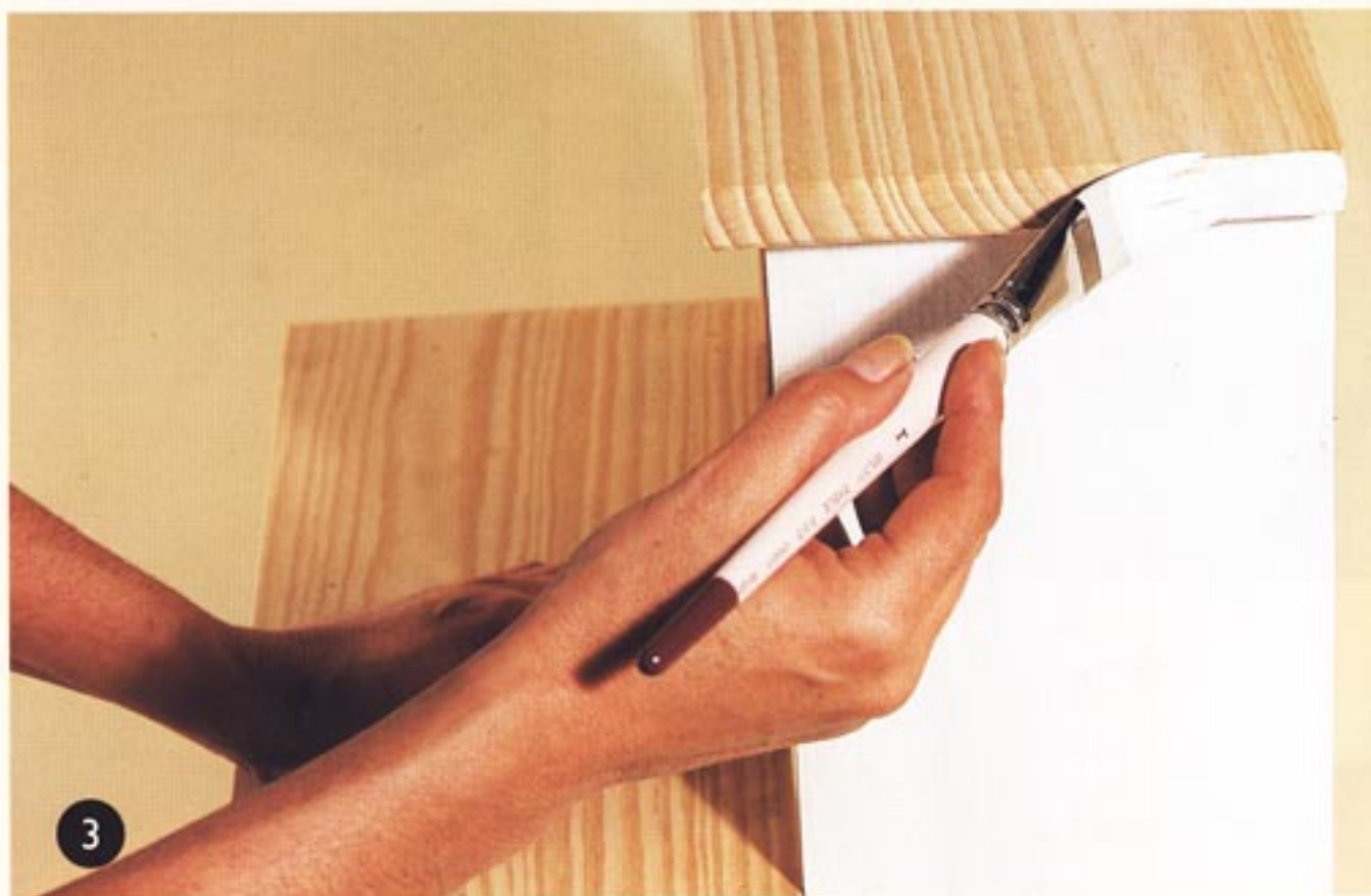
Фото 3. Нанесите на поверхность слой грунтовки и дайте ему высохнуть. Чтобы получить ровную поверхность, снова обработайте ее наждаком.
