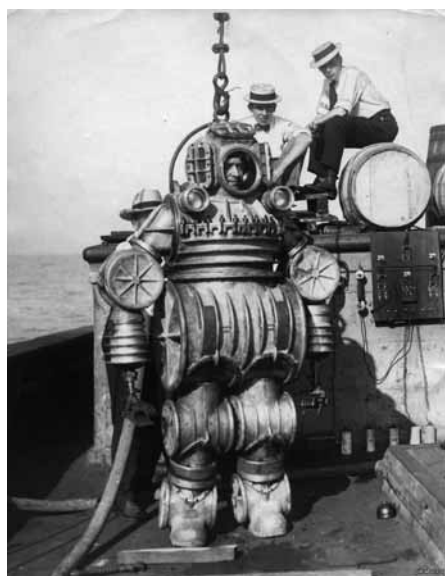
Ил. 3. Ранняя западная модификация водолазного костюма, 1907
