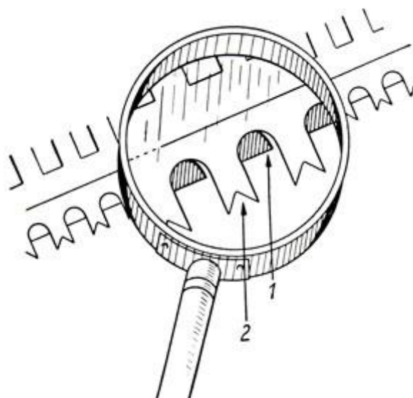
Рис. 52 а. Новая специальная бритва для филирования под увеличительным стеклом 1 — режущая плоскость 2 — перерыв режущей плоскости
