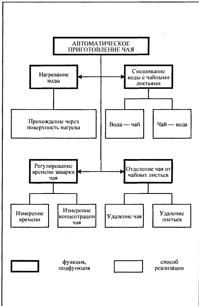
Рис. 26. Схема «функция — способ реализации» для автоматической заварки
