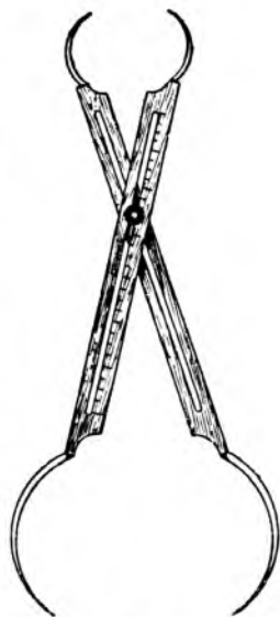
Рис. 9. Масштабный циркуль. Применяется для проверки пропорции при работе с уменьшением или увеличением по сравнению с моделью
