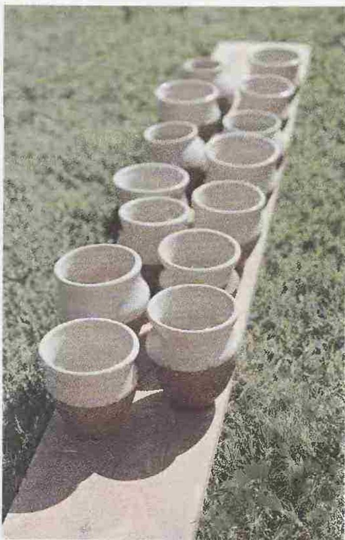
Сушка сосудов различного размера, покрытых ангобами
