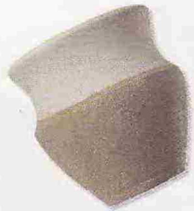
Ангобы изменяют краску материнской глины. Розовая краска переходит в белую, белая — в красную и т. д.
