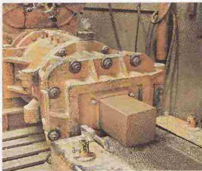
Механическая формовка глины. На рисунке показана штамповочная машина для формовки.
