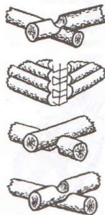
Рубка углов: в обло, в лапу, в охлуп, в крюк
