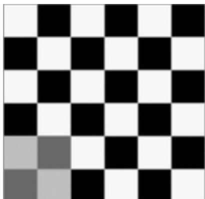
Ил. 3.14. Схема простого полотняного переплетения
