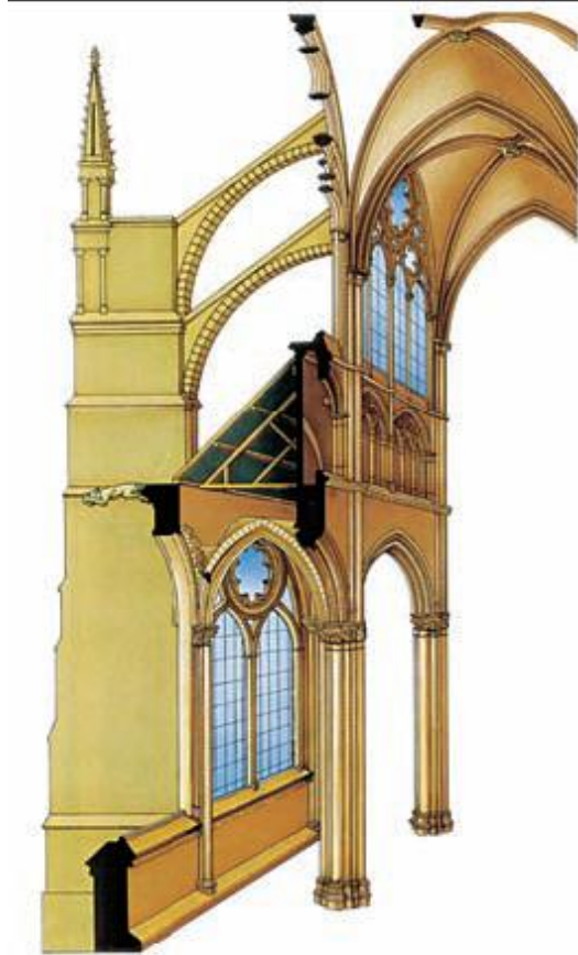
Контрфорсы и арк бутаны собора в Амьене
