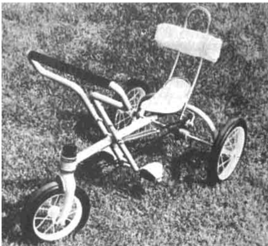
Тренажер, действующий по принципу наименьшего усилия, предназначенный для детей с ДЦП. Машина может передвигаться благодаря как педальному, так и ручному приводу. Любая конечность, которой пользуется ребенок, помогает движению, а другие конечности тренируются. Дизайн Чарльза Ланиуса, студента Университета Пердью
