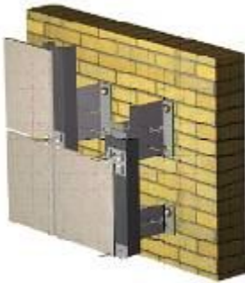
Рис. 23. Фрагмент вентилируемого фасада
