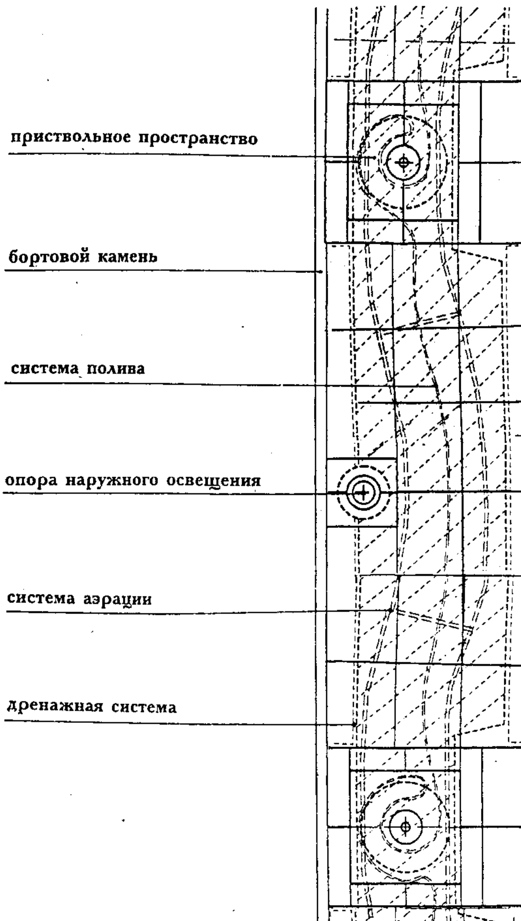
Рис.42. Посадочная траншея с основными системами жизнеобеспечения
