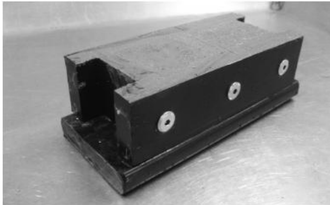
Рис. 47. Склеивание и выравнивание образцов кладочного раствора при помощи цементно-песчаного раствора
