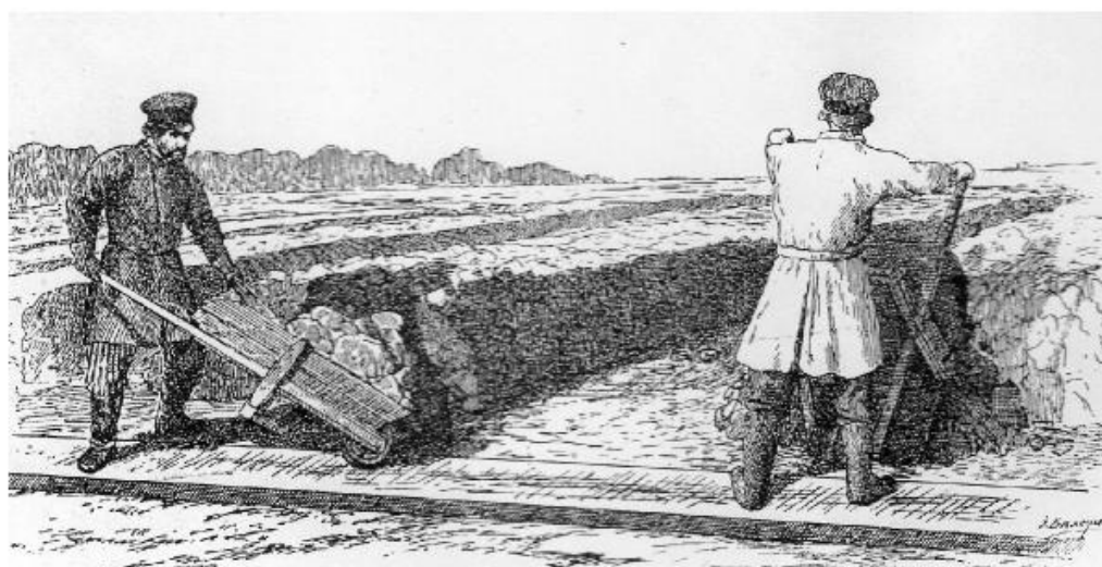
Рис. 16. Глинщики вывозят глину и складывают ее в гряды
