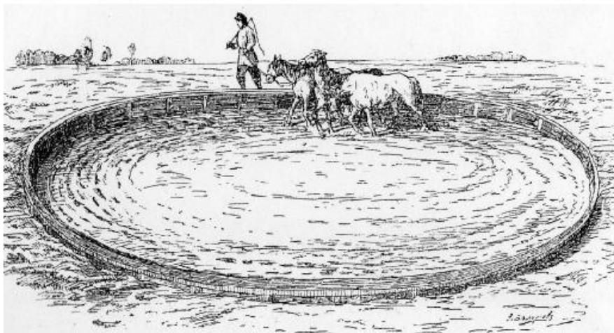
Рис. 20. Мятье глины животными
