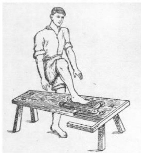
Рис. 22. Форма без дна для изготовления кирпича и формовка кирпича подпятным способом
