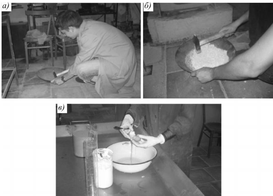
Рис. 71. Добавки для реставрационного штукатурного и кладочного раствора: а – цемянка; б – известняк; в – яичный белок
