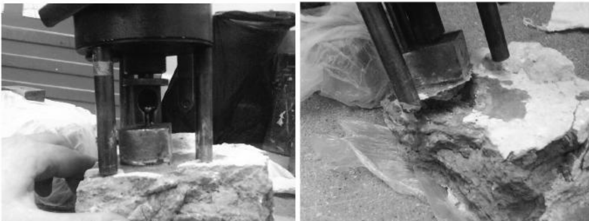
Рис. 50. Испытание адгезии на отрыв при помощи адгезиметра
