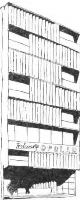
Рис. 95. Вертикально закрепленные солнцезащитные устройства на западной стене и горизонтально закрепленные устройства на южной стене здания филиала Национального городского банка Нью-Йорка в гор. Нагойя (Япония). Архитекторы Раймонд и Радо
