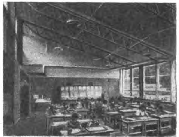
Рис. 55. Типичная выходящая на север классная комната с верхним светом, устроенным в южной стене
