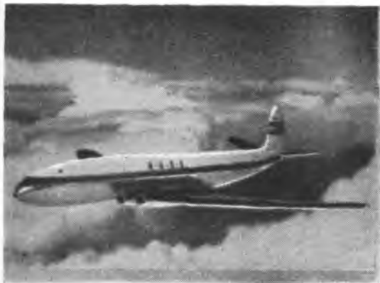
Рис. 168. Белая окраска стен кабин самолетов уменьшает тепловое воздействие солнца
