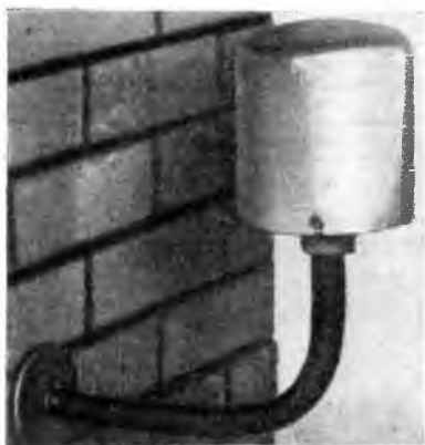
Рис. 171. «Погодостат», измеряющий теплопотери на любых наружных поверхностях
