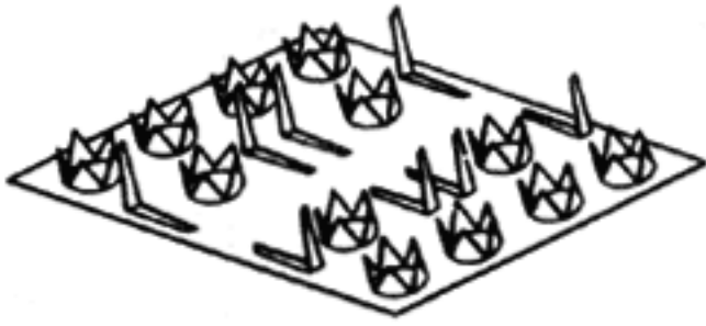
19а Гвоздевая плита системы «Туинаплайт». Когти у круглых отверстий используются для передачи усилий, гвозди у продолговатых отверстий — для анкерки гвоздевой плиты
