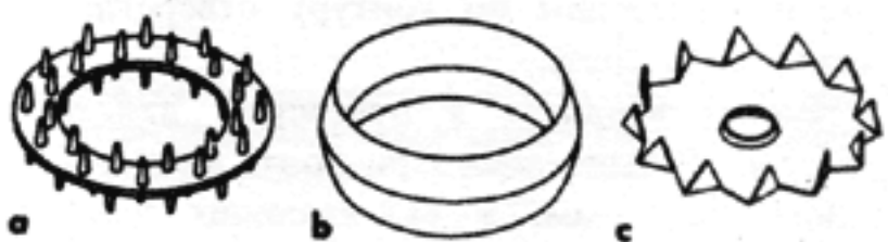
8: а — двухсторонняя шпонка (система «Гека»); б — двухсторонняя кольцевая шпонка (система «Апель»); в — односторонняя зубчатая шпонка (система «Бульдог»). Шпонки особой конструкции обозначают следующим образом: название системы, диаметр в мм, диаметр болтов в мм. Пример: одностороннее соединение (система «Гека»), наружный диаметр 65, болты М 16
