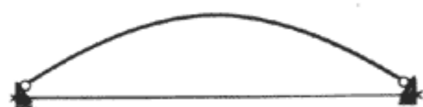
Формы осевых линий арок при различных нагрузках Распор воспринимается затяжкой
