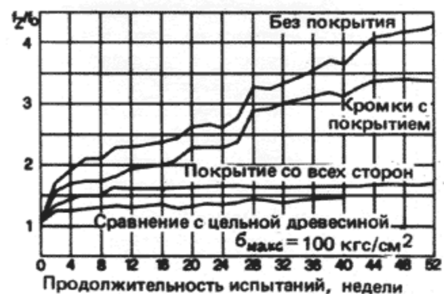
50 График относительных прогибов f_z/f_0 древесностружечных плит толщиной 25 мм, склеенных фенольной смолой, при семидневных циклах напряжений от \sigma_0 до \sigma_0/2
