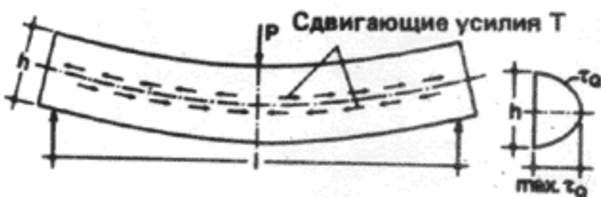
39 Напряжения скалывания при изгибе и их распределение
