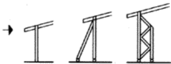
Зашемленные подпорки и стойки
