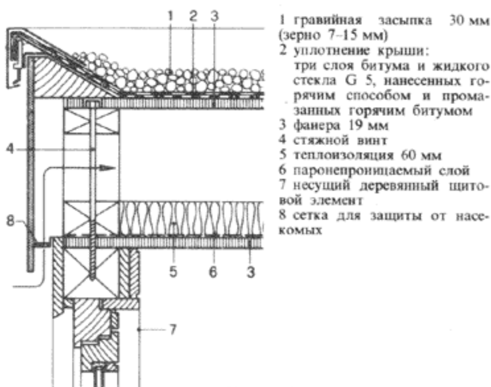
38-39 Кровельные щиты соединены со стенами заподлицо
