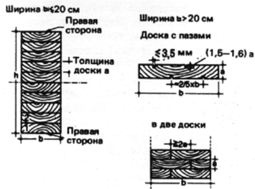
18 Структура пакета клееных досок
