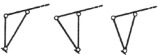
V-образные стойки рамы
