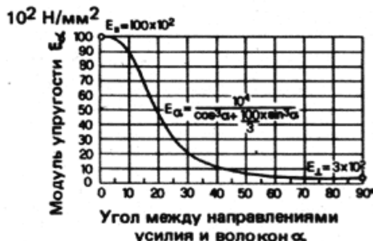
31 Зависимость модуля E от угла \alpha для хвойной древесины
