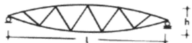
Рыбовидная ферма: a = 2,5-6 м; l = 20-50 м; h = l/8-l/10
