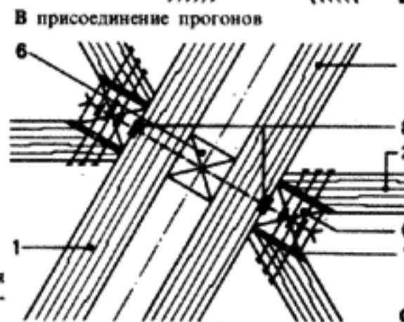
С главная и вспомогательная балки
