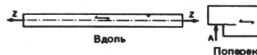
37 Напряжение растяжения вдоль и поперек волокон
