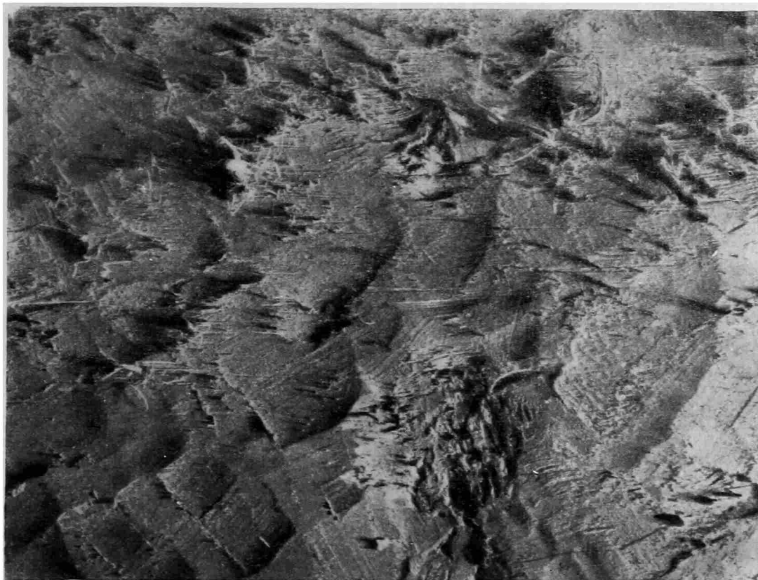
Рис. 2. Следы отески доски, отколотой от сучковатого бревна в сыром виде.
