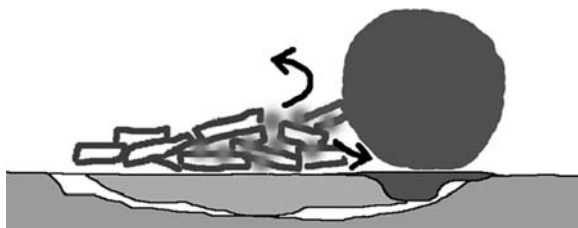
Рис. 7-45. Направление дымовых потоков в очаге экранного типа
