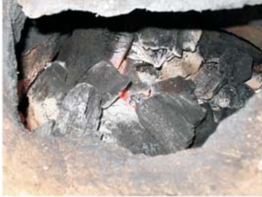
1 — Крупные куски березового угля позволяют воздуху легко распространяться в печи
