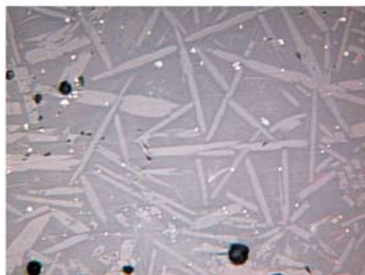
3 — Микроструктура шлака экспериментальной плавки 10. Длина снимка 0,54 мм. Призмы и иглы оливина и мелкая магнетитовая сыпь
