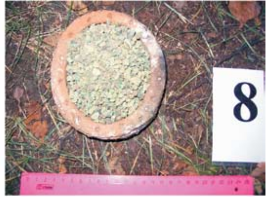
2 — Плавильная чаша, заполненная окисленной рудой
