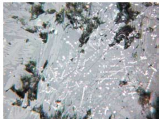
4. — пос. Покровское, обр. 1320, II мин. группа, длина снимка 0,46 мм: кристаллы оливина (светло-серые), дендриты магнетита (светлые) и мелкие корольки меди
