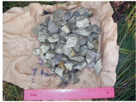
2 — Куски халькопирита размером 3—4 см, подготовленные для плавки
