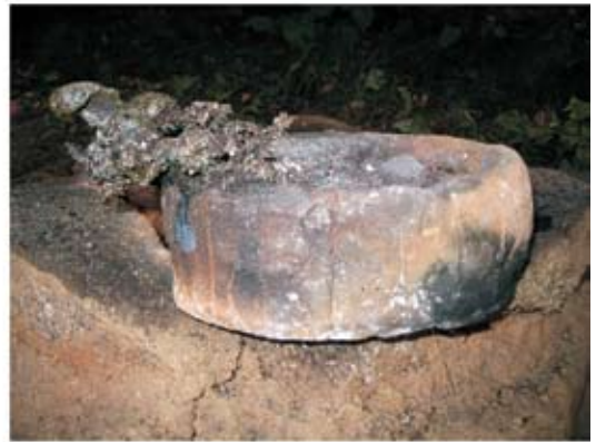
4 — Плавильная чаша после плавки. С расплавившимся шлаком активно контактирует лишь верхняя часть стенок, но чашу можно использовать заново
