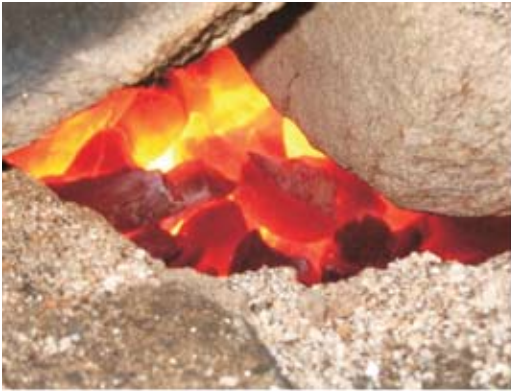
1 — Горение угля в печи с окисленной рудой осуществляется почти без пламени и дыма. По цвету углей визуально хорошо различимы разнотемпературные области. Так, под верхним слоем угля видна ярко-белая область температурного максимума
