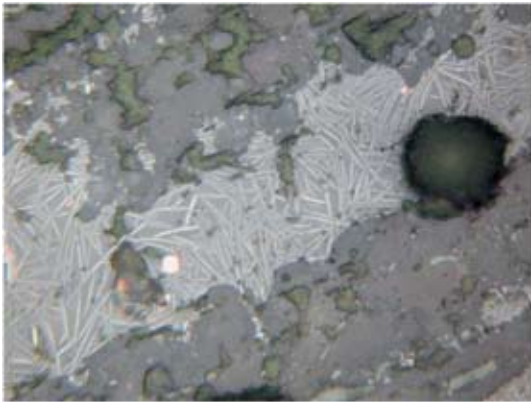
1. — пос. Ивановское, обр. 1305, IV мин. группа, длина снимка 0,46 мм: мелкие иглы делафоссита, медь и малахит в пространстве между фрагментами песчаника
