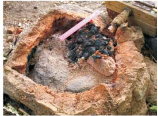
2 — Разбор печи. Стенки прокалены до красного цвета на значительную глубину
