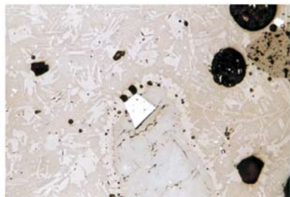
6 — Аркаим. Образец 680. Шлак I минералогической группы. В стекле (темно-серое поле) крупное зерно серпентинита (голубовато-серое внизу) с включением зерна хромшпинелида (светлое) и черные поры. По краю зерна серпентинита идет формирование кристаллов оливина. Призматические и игольчатые кристаллы оливина хорошо представлено и в стекле
