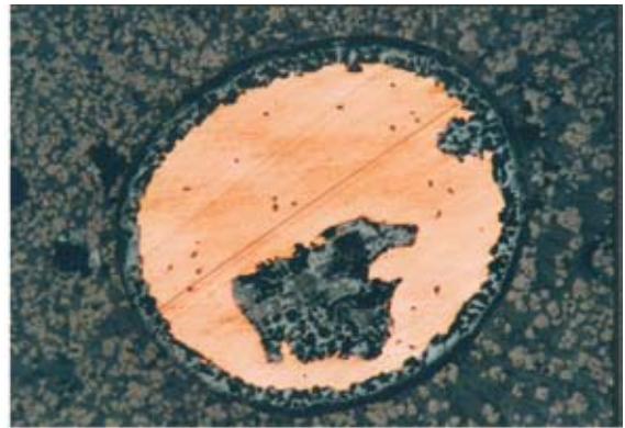
2 — Синташта. Образец 873. Шлак I минералогической группы. Крупный королёк меди с включением куприта и купритовой каймой и частицы магнетита в стекле
