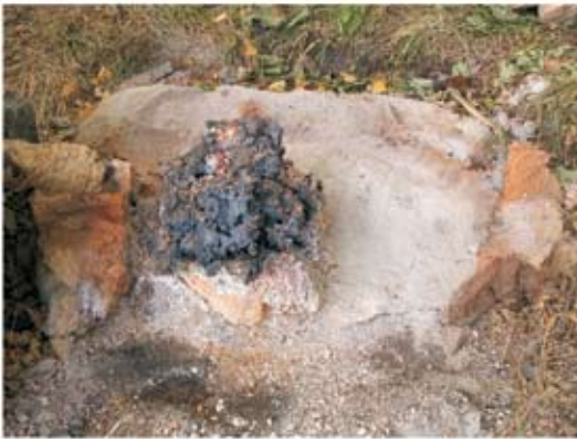
3 — Разбор экспериментальной печи. Перед соплом виден столб образовавшегося шлака. Основания стенок окрашены в красный цвет. Слой обмазки пода золистого цвета. Под ним в центре видно пятно красного прокала, а по периметру и под основаниями стенок прокал имеет черный цвет, поскольку сюда не было проникновения кислорода.
