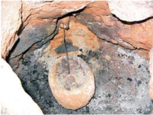
1 — Печь с плавильной чашей после плавки. Палочкой показано направление дутья от сопла. Красный провал вокруг сопла маркирует область окислительной атмосферы. Стенки вокруг темные, вероятно, благодаря формированию в этой области монооксида углерода. Но верхняя часть стенок красная, видимо за счет поступления воздуха сверху
