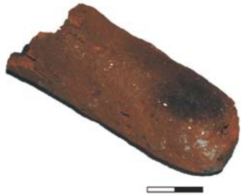
4 — Сопло после использования. На фото хорошо видно, что оно не ошлаковано
