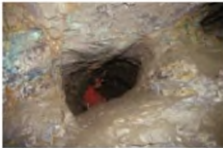
Abb. 44 Im Inneren des Berges sind die Reste von alten Stollen angeschnitten worden. Typisch ist ihr unregelmäßiger Querschnitt. Gut zu erkennen sind die grünen (Kupfer) und gelben (Zinn) Erze
