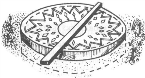
Рис. 27. Проверка поверхности рисунка рейкой во время укладки мозаики
