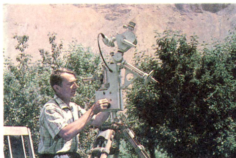
Ю. Л. Соколов ведет измерение солнечного спектра с помощью сконструированного им кварцевого монохроматора.
