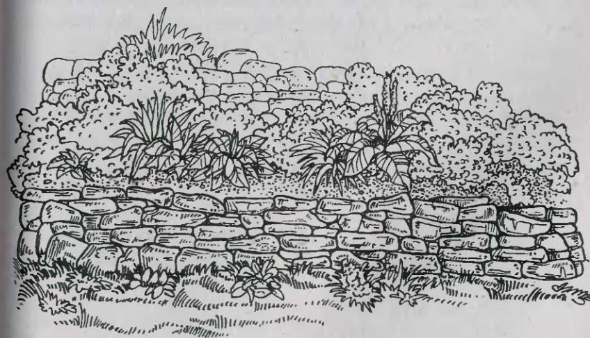
Подпорная стенка из плитняка
