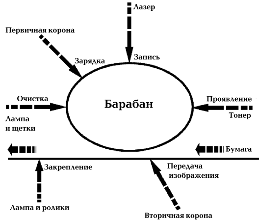
Рис. 1.7. Процесс лазерной печати
