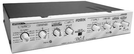
Рис. 6.13. Процессор эффектов Fostex DE-1
