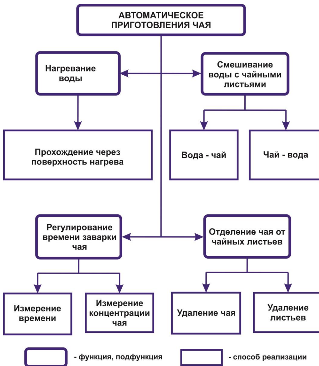
Рис. 24. Схема «функция – способ реализации» для автозаварки
